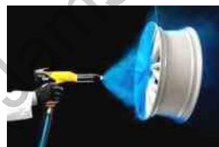
Fig: 14.14 Spray paint
